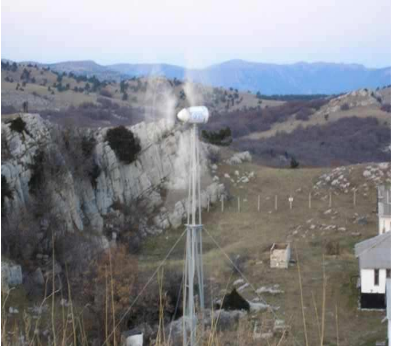
Рис.8. Использование ВЭУ-08 в горной местности для автономного энергообеспечение удалённых неэлектрифицированных потребителей. Размытость лопастей, свидетельствует о работе ВЭУ. Аналогичным образом с помощью ВЭУ-08 решена проблема автономного электроснабжения для освещения и работы аппаратуры: - ГМС "Пожижевская" (в Карпатах возле горной вершины Говерла); - подразделения МЧС, дислоцированного в Крыму на горе Ай-Петри.
